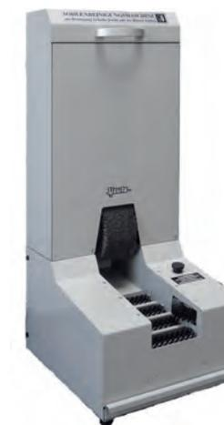
Vier Walzenbürsten reinigen die Sohlen, durch die beiden seitlichen Tellerbürsten werden die Sohlenränder gesäubert. Die Oberlederbürste sorgt für die Reinigung des Oberschuhs. Der abfallende Schmutz wird in einer großen, leicht zu reinigenden Auffangschubblende aufgefangen. Der Rundriemenantrieb gewährleistet den guten Durchzug der Bürsten.
