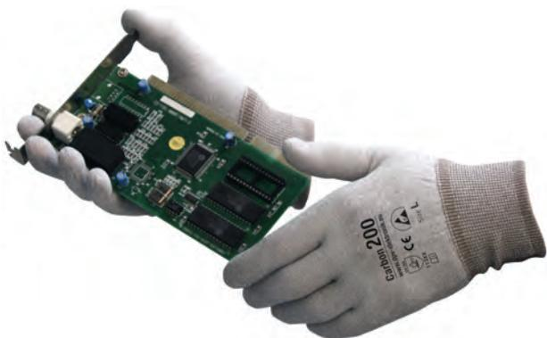
ESD-Handschuhe werden zur Ableitung der statischen Elektrizität eingesetzt. Dies ist nötig, da statische Entladung empfindliche Elektronik beschädigen oder sogar zerstören kann, wenn ohne ESD-Schutz montiert wird. Ein ESD-Handschuh muss strenge Anforderungen im Hinblick auf die elektrostatische Ableitfähigkeit erfüllen.
