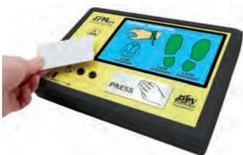
Mit dem integrierten Multi-RFID Leser zur Personenidentifikation wird die hinterlegte Zugangsbechtigung abgefragt.
