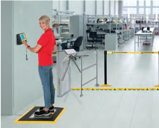
In Verbindung mit dem modernen EPApro® Personenerdungs-Testsystem kann die Funktion der persönlichen ESD-Schutzausrüstung beim Zugang zu einer EPA-Schutzzone überprüft und dokumentiert werden.
