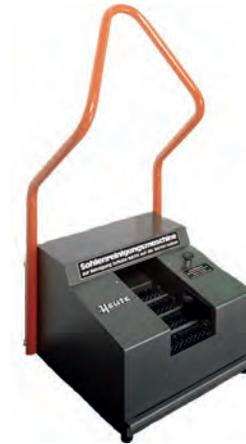
Vier gegeneinanderlaufende Walzenbürsten reinigen die Sohlen von unten, zwei seitlich rotierende Rundbürsten säubern die Sohlenränder. Der abgebürstete Schmutz wird in einer großen, leicht zu entleerenden Auffangschubblende unter den Bürsten aufgefangen.
