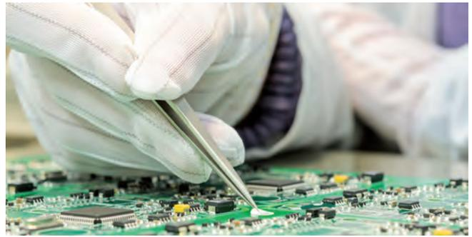
Die Polyester-Handschuhe mit eingewebten Carbon-Leitfasern verfügen über gute Ableitwerte und sind auch für den Einsatz in Clean-Räumen geeignet.
