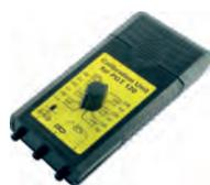
Unité de calibration équipée de toutes les résistances nécessaires pour tester sur place les valeurs limites de la station de test PGT 120
