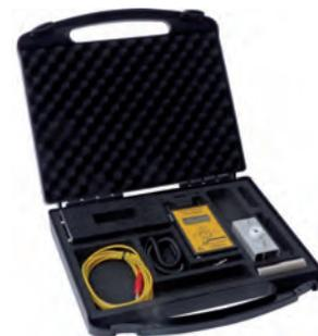
EFM®51 avec support conducteur et tête de mesure MK 51. En attachant la tête de mesure MK 51 l'électromètre EFM®51 peut être utilisé pour la mesure de vérification de la tension du corps (test de marche) selon IEC 61340-4-5. La tête de mesure MK 51 est spécialement calibré à EFM®51. Les valeurs "PEAK" positive et négative de la tension du corps mesurée sont affichées.
