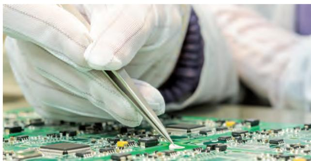
Les gants en polyester avec des fibres conductrices en carbone intégrées ont de bonnes valeurs de dissipation et sont également appropriés pour l'utilisation dans des salles blanches.
