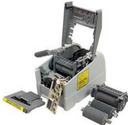
**Pratique:** l'unité de transport de ruban complet peut être changée **sans outil** et en 5 pas. Protection des doigts avec contact de désactivation; le distributeur peut être mis en position diagonale; alimentation 2AC 100V, 120V, 220-240V, 41W. Poids 2,3 kg.
