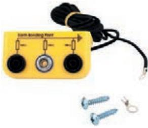
Bornier de mise à la terre avec 3 connecteurs, montés latéralement à angle, comme point de connexion à la terre, câble de mise à la terre de 3 m avec œillet de vis M4 / connecteur 1 MOhm résistance de sécurité par connexion
