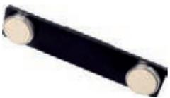
pour mesurer des résistances des surfaces verticales à une distance fixe de 30 cm; pour connecter à un résistivimètre haute résistance; caoutchouc conducteur avec particules d'argent: poids 950 g; dimensions: 385 x 85 x 70 mm (LxLxH); diamètre du caoutchouc 63,5 mm
