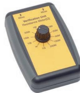
Le Verification Unit sert de vérifier rapidement des mesureurs de résistance avant mesurer.
