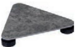
Pour déterminer la résistance électrique d'un revêtement de sol élastique en conformité avec EN 1081; pour connecter à un résistivimètre haute résistance
