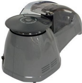
Distributeur de rubans adhésifs type A619 avec entraînement électrique et table tournante, pour des rubans adhésifs d'une largeur de 3 à 25 mm. Il coupe des longueurs de 10 à 61 mm. Approprié pour toutes les tailles de rouleau jusqu'à Ø150 mm. Poids 2,1 kg, alimentation 100-240V.
