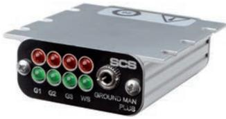
Le moniteur **Ground Man Plus** est conçu pour surveiller l'impédance de terre des lieux de travail, des outils et des machines. Le contrôle de l'impédance de terre de jusqu'à trois bornes de mise à la terre dure est possible. En plus le moniteur **Ground Man Plus** peut surveiller la mise à la terre par bracelet d'une personne en moyen d'un système bracelet à double conducteur / câble de terre.
