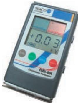
Le mesureur de champ FMX 004 est un appareil de mesure compact pour détecter et mesurer des charges électrostatiques. Grâce à son format compact il est très pratique et facile à opérer via les quatre boutons.
