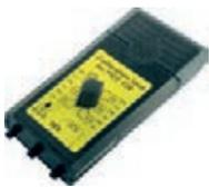
Unité de calibration équipée de toutes les résistances nécessaires pour tester sur place les valeurs limites de la station de test PGT 120
