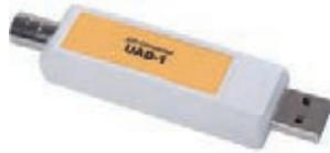
Le convertisseur analogique numérique, clé UBS et câble de connexion BNC
