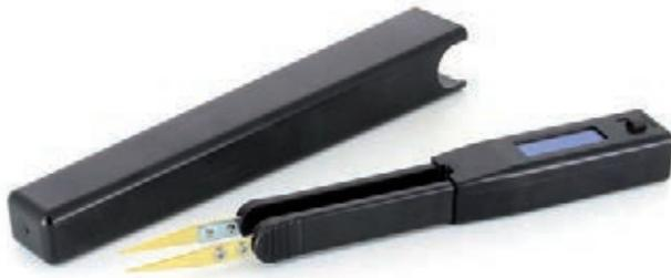
Appareil de mesure automatique et adaptif pour mesurer LEDs CMS avec des brucelles précises et plaquées or. Smart Tweezers™ Iskra™ facilite la mesure de différents types de LEDs déjà montés sur une platine. Opération confortable à une seule main, détection automatique de la polarité LED, affichage d'une chute de tension, préréglage de l'intensité du courant d'essai.
