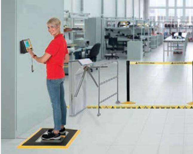
En combinaison avec le système d'essai de mise à la terre des personnes EPApro® moderne il est possible de vérifier et documenter la fonction de l'équipement de protection ESD personnel en accédant une zone protégée EPA.
