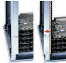
Magazin verriegelt Magazin entriegelt
